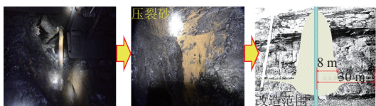
图4 井下煤层气井人工裂缝观测及示意图
